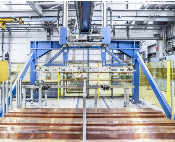
Bild 2 | Das Gantry System ist der Kern der Automatisierung für die beiden autark arbeitenden Stanzmaschinen. Unter dem Portalkran gibt es zwei Lagerbereiche für je 40t Material unterschiedlicher Abmessungen.
